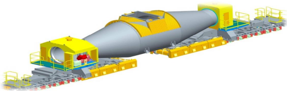
Figura 3 - Carro torpedo: Vagão para carregamento de gusa líquido para a Aciaria.
