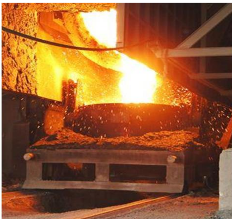
Figura 13 - Pote recebendo escória líquida do vaso convertedor
