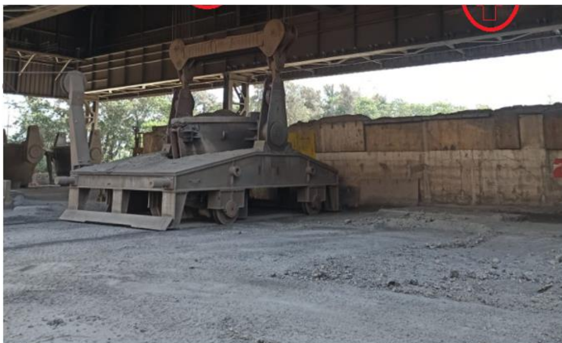
Figura 8 - Pote de escória posicionado no carro transportador em frente a baia
