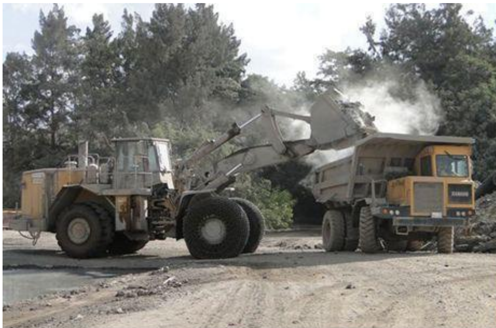
Figura 16 - Pá carregadeira despejando escória em um caminhão Fora de estrada.
