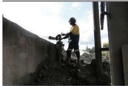
Figura 14d – Operador ajustando o posicionamento do Bico de Pulverização de água na baía.
