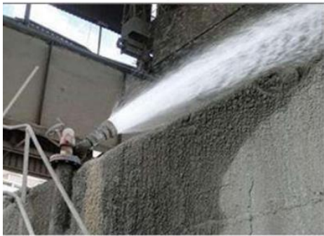
Figura 14c – Bico spray posicionado para resfriamento da escória na baía.
