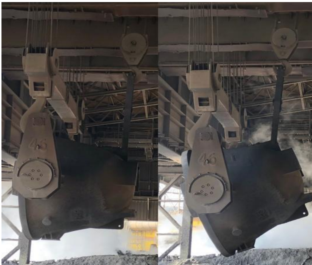
Figura 9 - Pote de escória sendo içado pela ponte rolante para realizar o despejo na baía.
